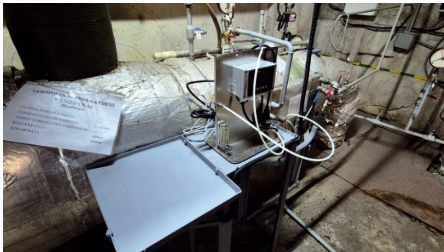
3 pav. Deguonies koncentracijos tinklo vandenyje matavimo prietaisas
