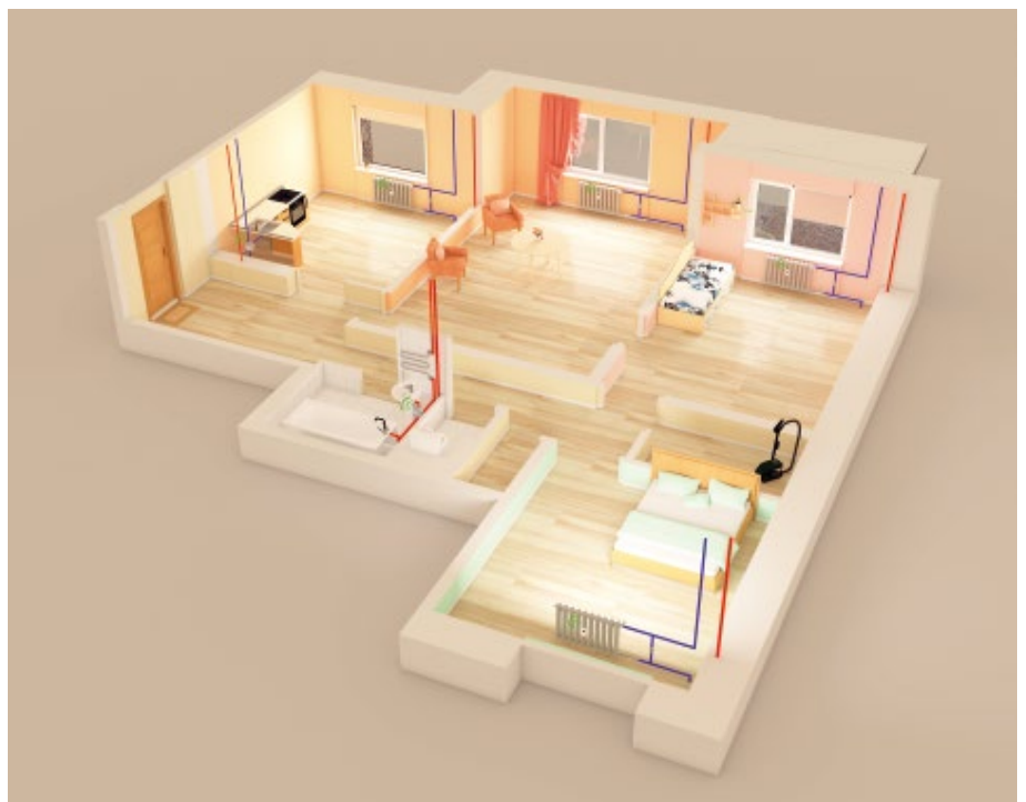
Butas su subalansuota šildymo ir karšt vandens sistema, dalikliais ant radiatorių ir nuotoliniu rodmeniu nuskaitymu
