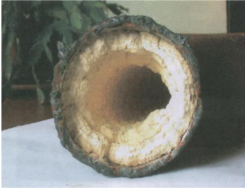
Centrinio šildymo sistemos vamzdyje dėl neapdoroto vandens prasiskverbimo susiformavusios nuoviros
