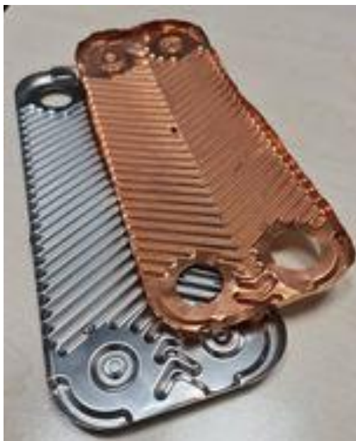
11 pav. Šilumokaičio plokštelė ir litavimo medžiagos plokštelė.
