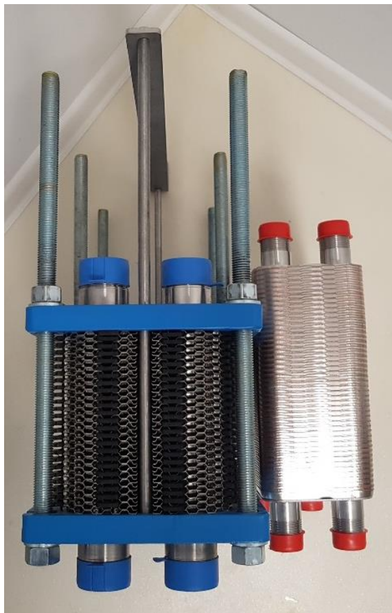
17 pav. Tos pačios šiluminės galios šilumokaičių gabaritų palyginimas.
