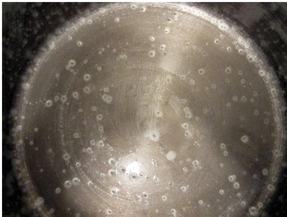
3 pav. Nerūdijančio plieno taškinė korozija.
