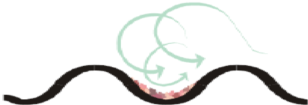
7 pav. Kaip turbulentinis srautas ir slyties įtempiai padeda išlaikyti šilumokaitį švarų
