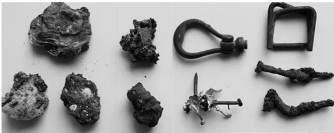
4 pav. Metalų ir baldų elementų likučiai dugno pelenuose
